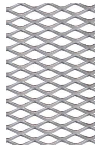
Siatka średnia 3 L 30,0 mm W 15,0 mm B 4,0 mm A 1,5 mm F o 46,3 %
