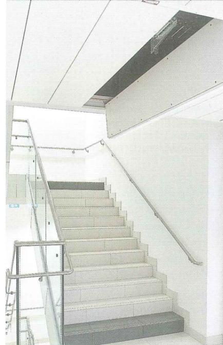
**PRAKTISCH.** Bei der Metall-Brandschutzdecke kann jede Kassette abgeklappt werden. Mehrere Kassetten können zu einer komfortablen Revisionsöffnung für Wartungs- und Installationsarbeiten verschoben werden.
