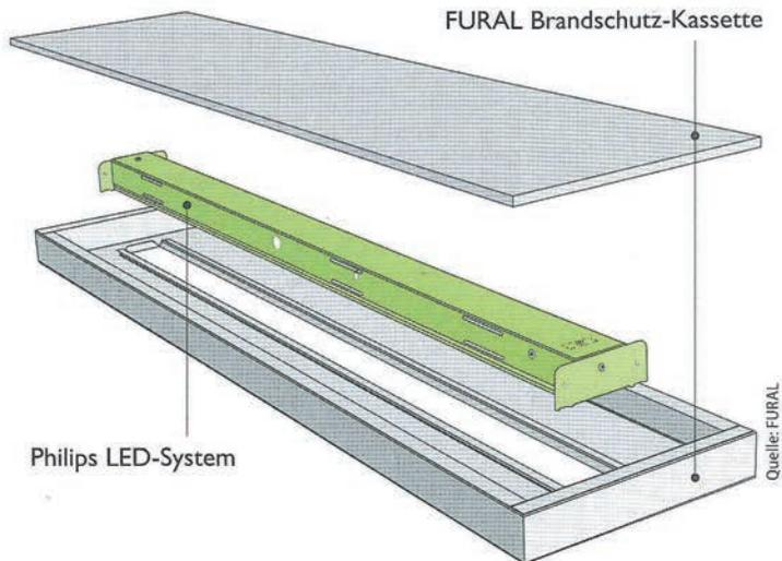
Die LED-Leuchte von Philips ist durch ihren flachen Aufbau komplett in die FURAL Brandschutzkassetten integriert. Dies gewährleistet den Brandschutz ohne zusätzliche Abkofferungen und eine niedrige Einbauhöhe.
