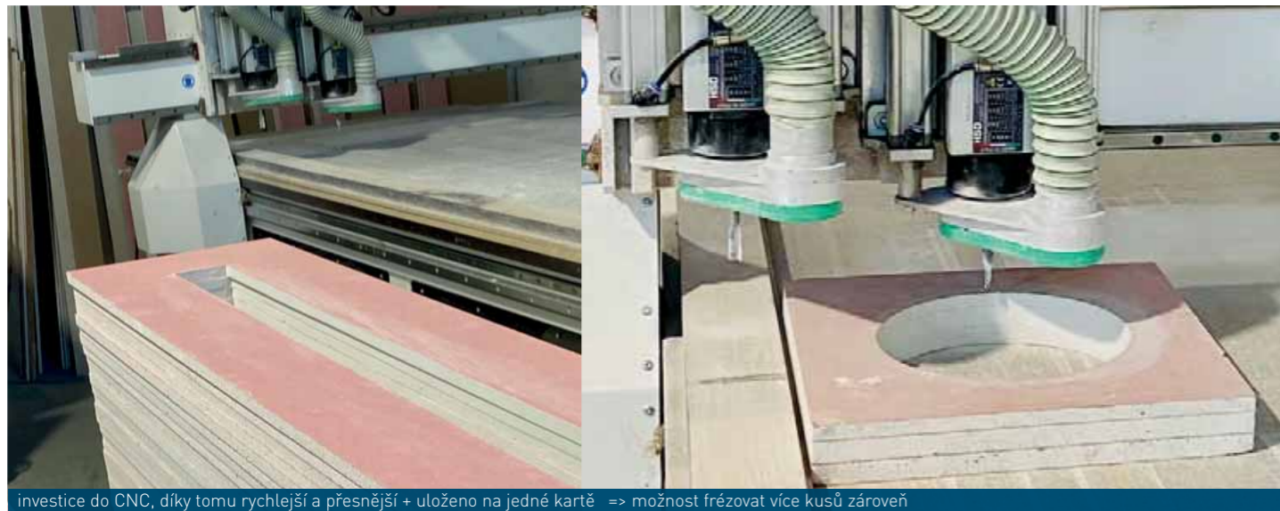
investice do CNC, díky tomu rychlejší a přesnější + uloženo na jedné kartě => možnost frézovat více kusů zároveň
