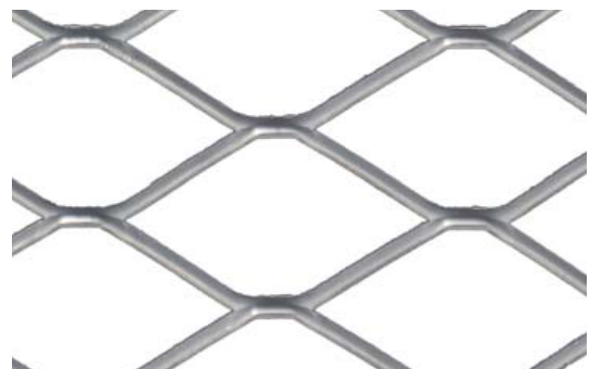
Masche 60 x 32 x 3 x 1,5 [mm] Oczko freier Querschnitt ca. 81,3% prześwit względny
